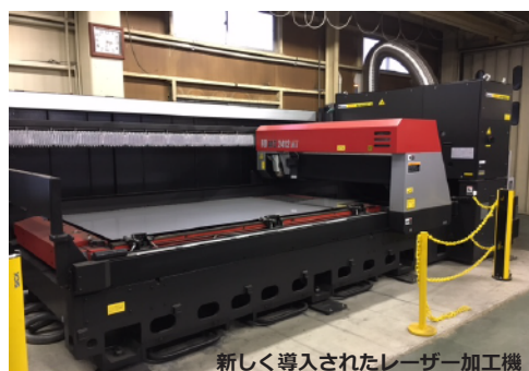
新しく導入されたレーザー加工機
